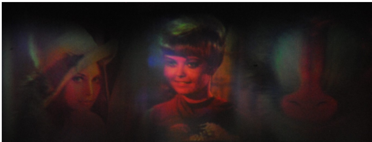
図2 高速2値位相変調素子を用いたフルカラーかつ画像拡大実験結果.
