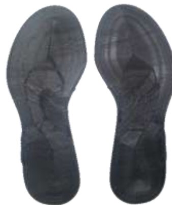
写真2 加硫ゴム3Dプリンタで試作した造形モデル
